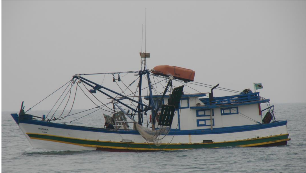
Figura 5. Embarcação do tipo traineira utilizada para a pesca do camarão-sete-barbas, com rede de arrasto-duplo, em Bertioga/SP.
